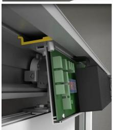
5.4 Установите натяжитель на несущий профиль в соответствии с размером А (смотри главу 4) и закрепите его винтами (Примечание: если позволяет место, уменьшите расстояние А на несколько сантиметров).
