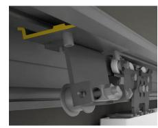
5.5 Установите тележки на несущий профиль привода и отрегулируйте положение верхнего колеса, чтобы их зафиксировать на рельсе. Тележки следует устанавливать, как показано в главе 4.
